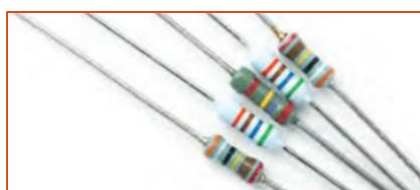
DOCUMENT 2 : RESISTORS UTILISES DANS LES CIRCUITS ELECTRIQUES
